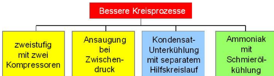
Bild 8-16 Im Vorhaben Swiss Retrofit Heat Pump untersuchte Wärmepumpenprozesse für hohen Temperaturhub
