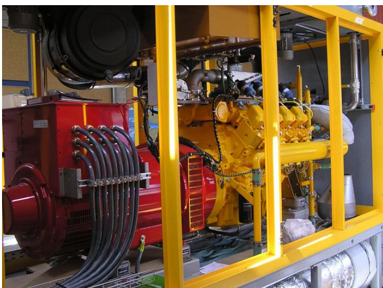
Bild 8-5 Blockheizkraftwerk mit 8-Zylinder-Swissmotor. Elektrischer Wirkungsgrad 38%, elektrische Leistung 280 kW, Heizleistung 389 kW, \text{NO}_x < 50 \text{ mg/Nm}^3 [Avesco, CH-4901 Langenthal]
