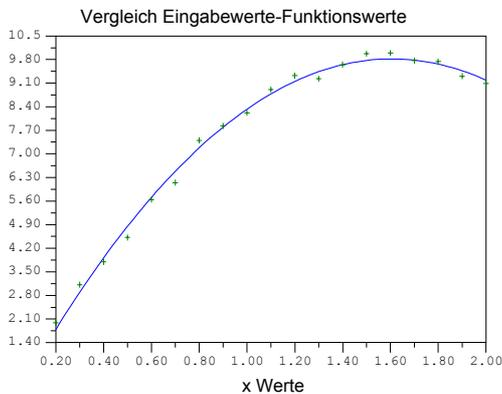
Das Programm **FitPol** dient der Polynom-Anpassung an Messwerte oder Diagrammpunkte für bis zu 30 Stützwerte mit Polynomen bis 5. Grades nach der Methode der kleinsten Fehlerquadratsumme für die folgenden Funktionstypen:
