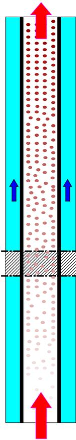
Das Programm **Membran** dient der Berechnung der Umkehrosmose, der Nanofiltration, der Ultrafiltration und der Querstrom-Mikrofiltration nach dem **Durchströmungs-Stofftransport-Modell** unter Berücksichtigung des Druckverlusts in der Konzentratströmung und des sich längs des Moduls ändernden Stoffübergangskoeffizienten.
