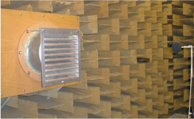
**Figur 3:** Messung der Strömungsgeräusche von Wetter-schutzgittern in Abhängigkeit der Strömungsgeschwindigkeit (aus [9]).
