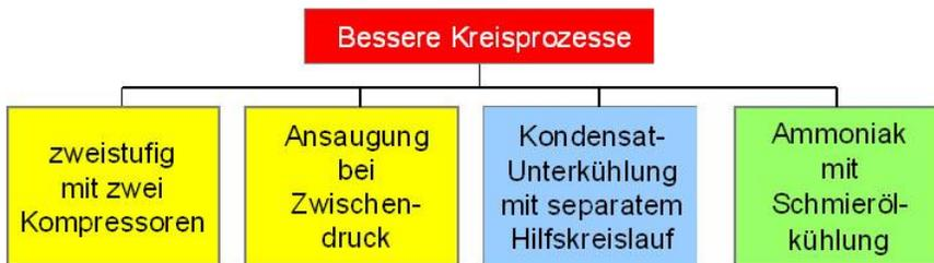
**Bild 4:** Im Vorhaben „Swiss Retrofit Heat Pump“ untersuchte Wärmepumpenprozesse für hohen Temperaturhub ([1], Bild 8-16)
