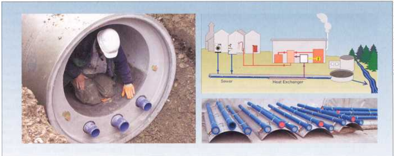
Bild 5 Rabtherm-Abwasserkanalelement (links), Prinzip und Rabthermelemente (rechts).
