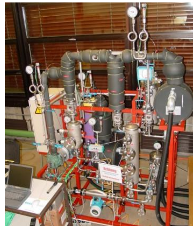
Bild 4: Versuchsanlage einer Ammoniakkleinwärmepumpe an der FH Rapperswil [ 3 ]
