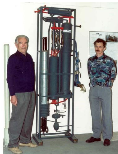
Bild 8: Diffusions-Absorptions-Wärmepumpe der Firma Creatherm
