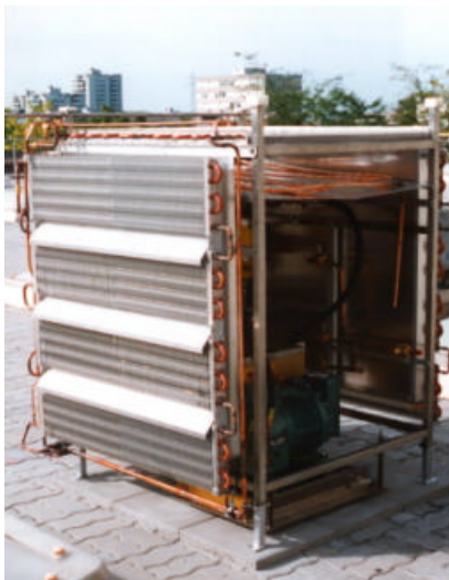
Bild 5: Wärmepumpe mit „stillem Verdampfer“ an der FH Muttenz [ 4]
